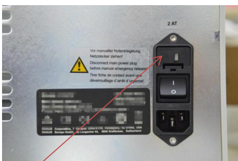
Sicherungsschublade mit Sicherung 4 AT
