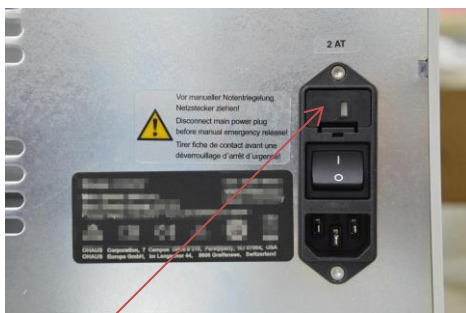
Cassetto portafusibili con fusibile 4 AT
