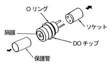
④ホルダにDOチップを取り付けます。 DOチップのコネクタピンには太い方と、細い方があります。向きに注意して、 ホルダにはめ、保護キャップを止まるまでしっかりと回してください。
